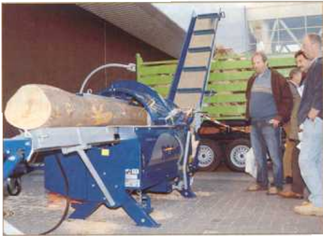
Links: Neu, der Tajfun RCA 320 Säge-spalter, der Stämme bis 32 cm verarbeitet.
